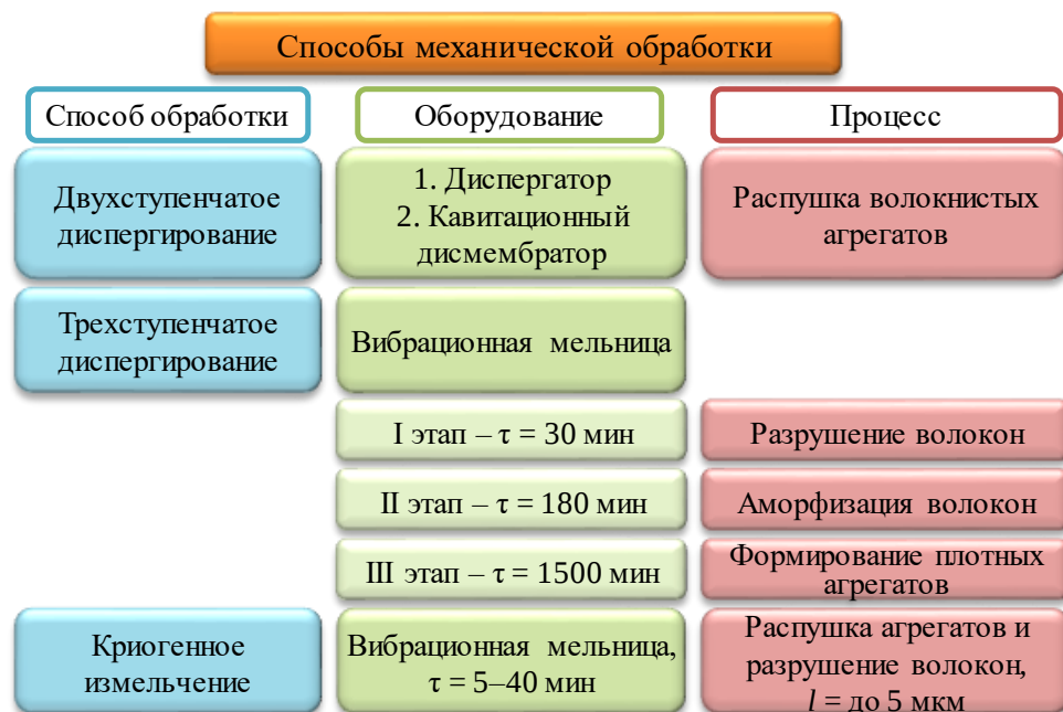
Рис. 6. Способы механической обработки хризотила Fig. 6. Flow-chart of chrysotile mechanical processing
