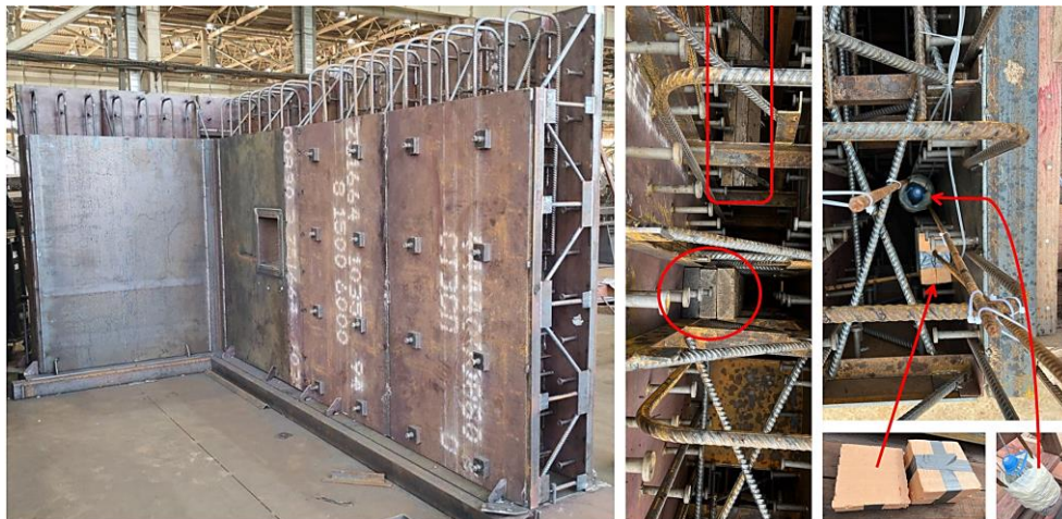
Рис. 3. Монтаж дефектов внутрь стены с внешним листовым армированием Fig. 3. Flaw detection in the wall with the outer steel shell
