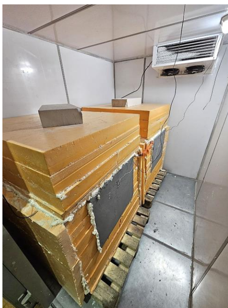
Рис. 1. Климатическая камера с испытательными стендами (общий вид)
