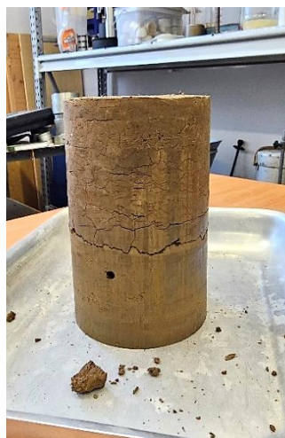
Рис. 5. Общий вид образца грунта после окончания испытания на приборе ГТ 1.1.8 и высушивания до постоянной массы
