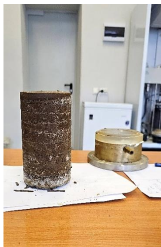
Рис. 4. Общий вид образца грунта после промораживания на приборе ППГ-1М
