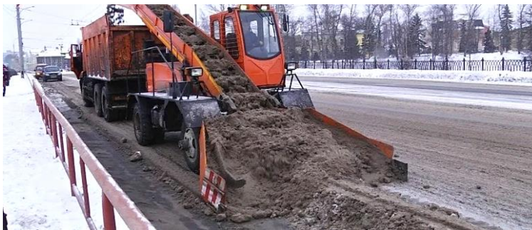
Рис. 3. Очистка дороги с использованием снегопогрузчика с автосамосвалом Fig. 3. Snowloader with dump truck
