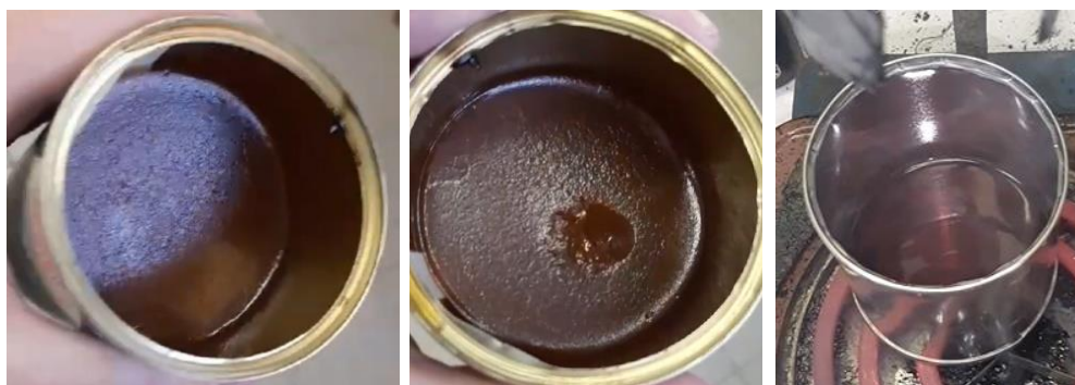
Рис. 2. Изменение агрегатного состояния ЛТМ от -35 до 68 °С Fig. 2. Physical forms of light tall oil within -35 to 68 °С
