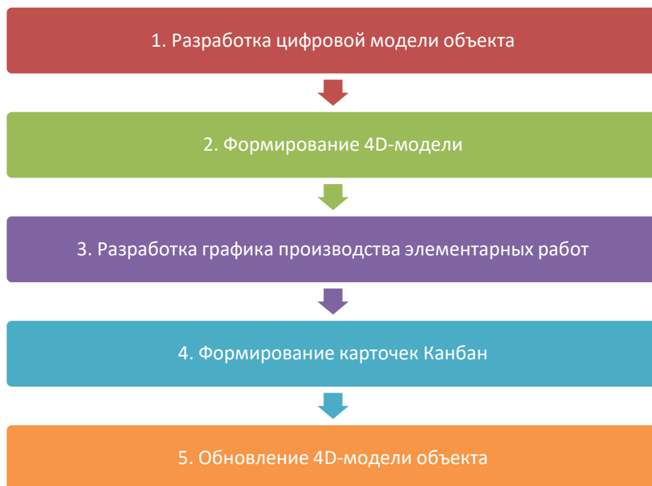
Рис. 3. Алгоритм внедрения технологий информационного моделирования и инструментов системы бережливого строительства Канбан
