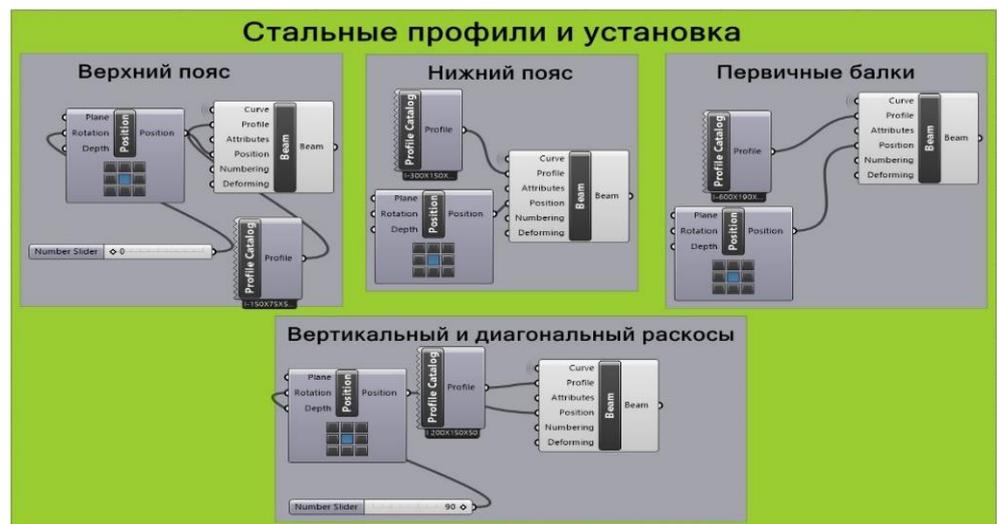
Рис. 3. Стальные профили из плагина Tekla Structures
