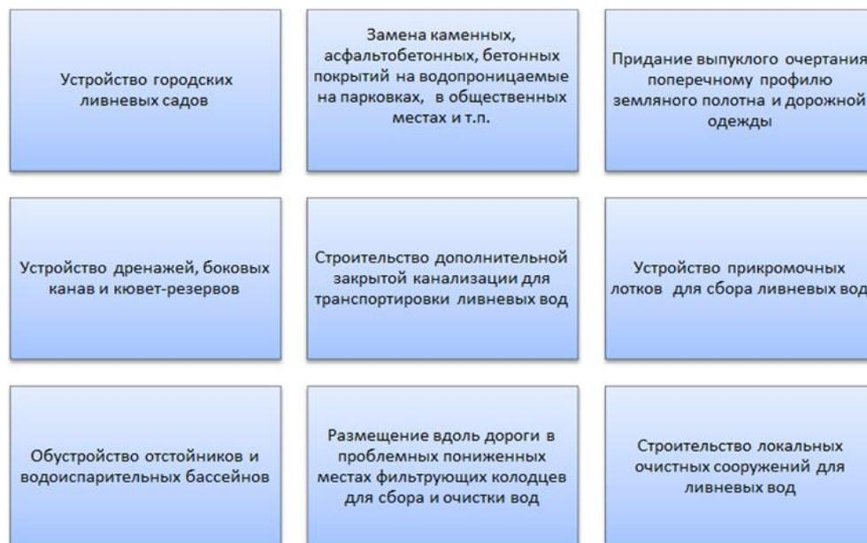
Рис. 2. Элементы комплексного обеспечения ливневой безопасности автомобильной дороги
