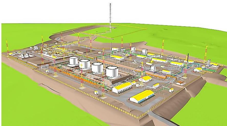
Рис. 10. Информационная модель «Установки подготовки нефти»
