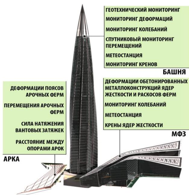
Рис. 1. Система автоматизированного мониторинга комплекса «Лакhta Центр»
