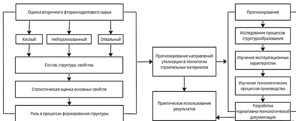
Рис. 1. Методология тестирования фторангидрита для производства строительных материалов
