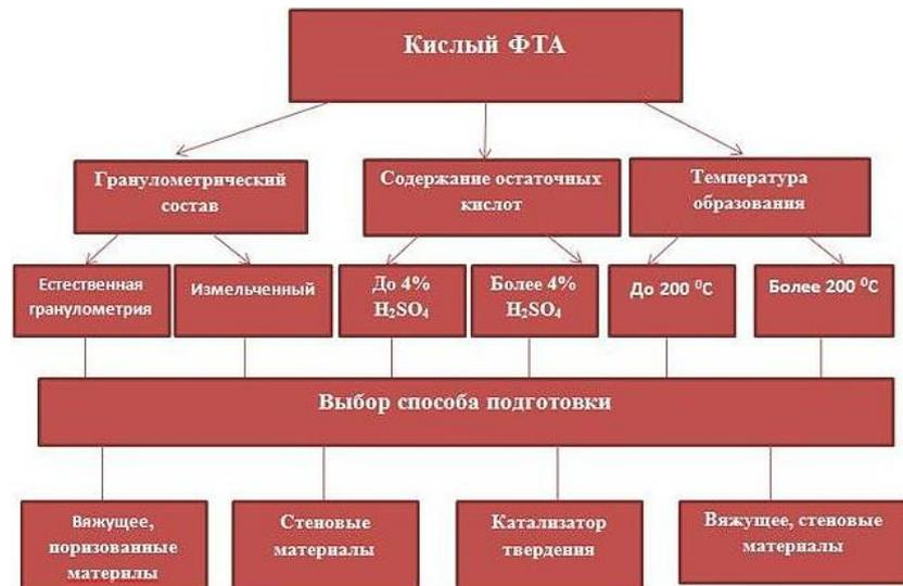
Рис. 2. Область применения кислого фторангидрита
