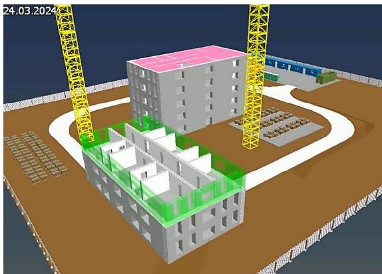
Рис. 8. 4D-модель возведения сборно-монокристаллического каркаса жилого здания [11]
