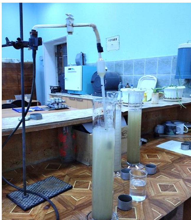
Рис. 8. Установка для определения гранулометрического состава грунта Fig. 8. Installation for grain size distribution estimation
