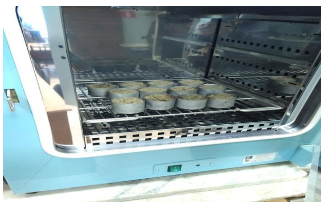
Рис. 9. Определение влажности проб грунта термостатно-весовым методом Fig. 9. Determination of soil moisture by thermostatic weight method
