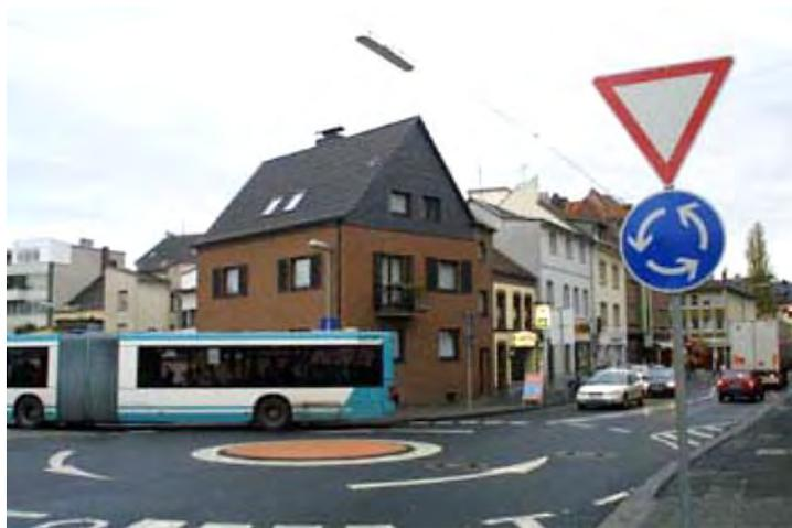
*Рис. 20.* Мини-кольцо диаметром 4 м с шириной полосы на кольце 3,75 м и с возвышением (до 20 см) в центре в виде полусферы. Краевая полоса шириной 1,5 м
