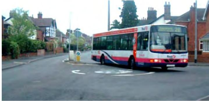
*Рис. 19.* Допускаемое движение крупных транспортных средств через островок на мини-кольцах [8]
