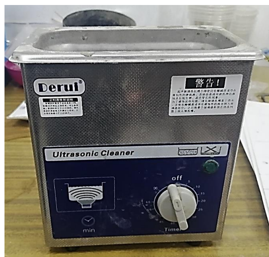
Рис. 7. Прибор для ультразвуковой обработки цементной суспензии
