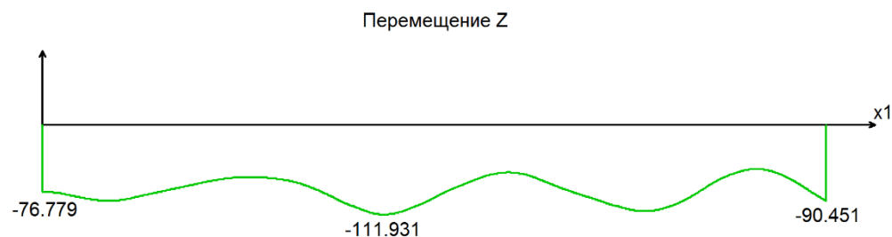
Рис. 5. График изменения максимального перемещения узла, выявленного в середине нижнего ребра грани, примыкавшей к грани коньковой зоны
