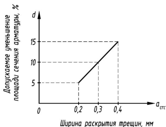
Рис. 3. Зависимость допустимого уменьшения площади сечения арматуры от ширины раскрытия трещин при их непродолжительном раскрытии
