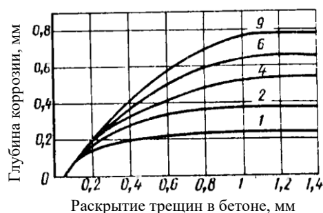
Рис. 1. Зависимость глубины коррозионного повреждения арматуры от ширины раскрытия трещины. Цифры у кривых – годы
