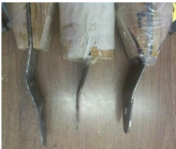
Рис. 6. Формы потери устойчивости стальных пластин при испытании стержневых элементов на сжатие
