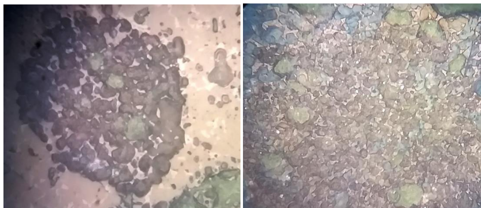
Рис. 9. Свободный оксид кальция на поверхности кристаллов
