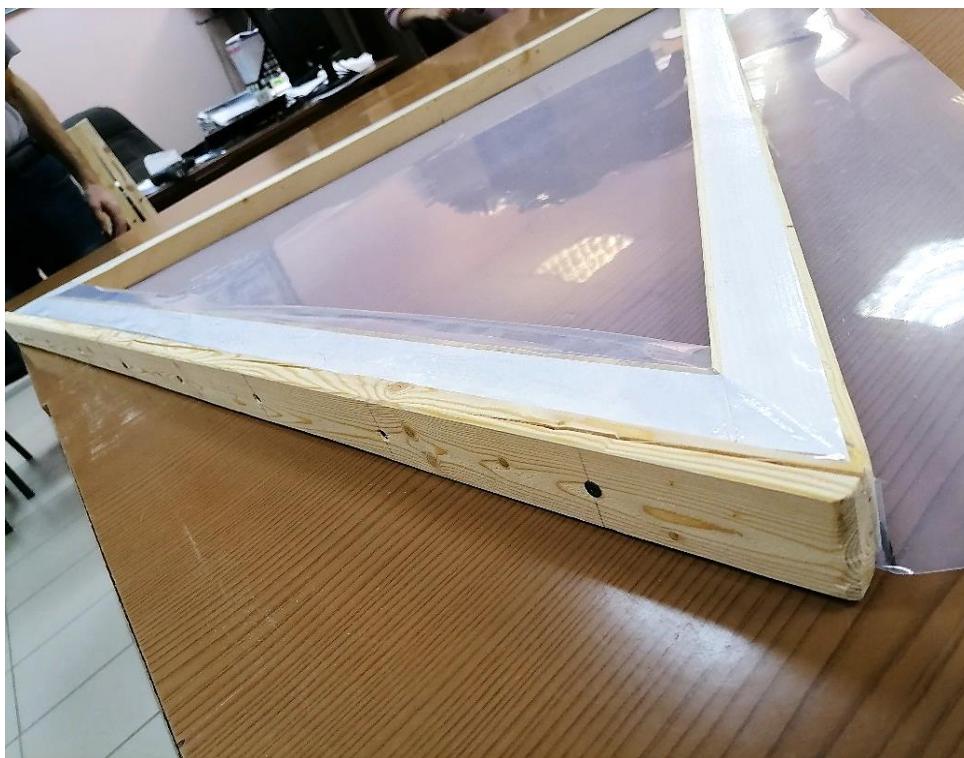
Рис. 4. Силовая рама с мембраной из пленки ЭТФЭ
