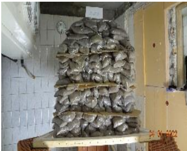
Рис. 5. Силовые испытания пленки ЭТФЭ на 16-м этапе загрузки при положительной температуре
