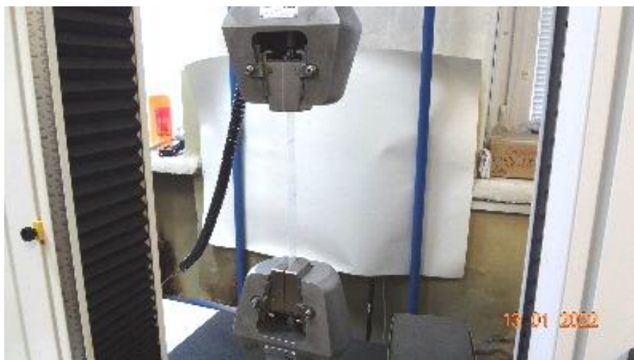
Рис. 2. Силовые испытания пленки ЭТФЭ
