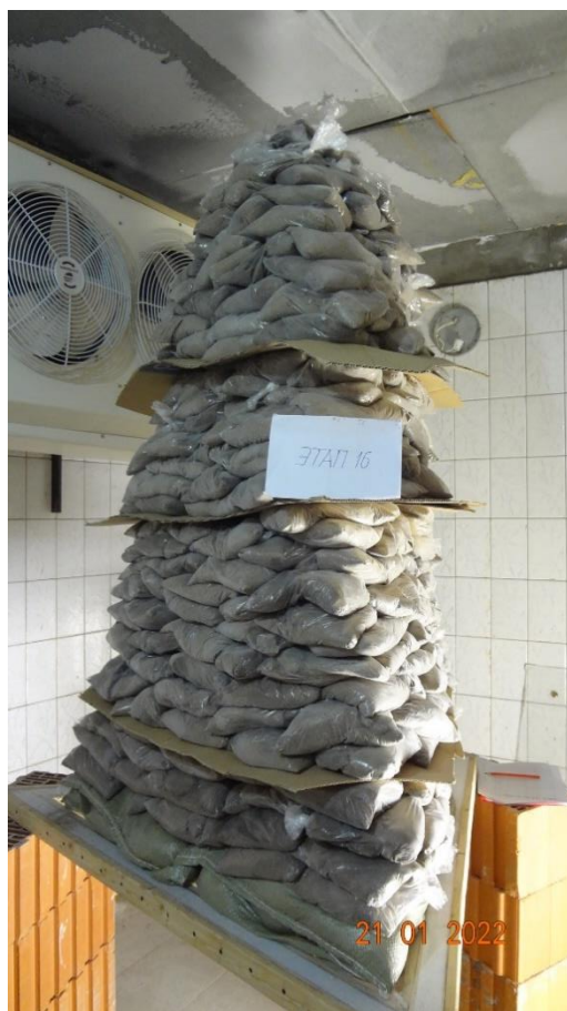
Рис. 6. Силовые испытания пленки ЭТФЭ на 16-м этапе загрузки при отрицательной температуре в климатической камере ТГАСУ
