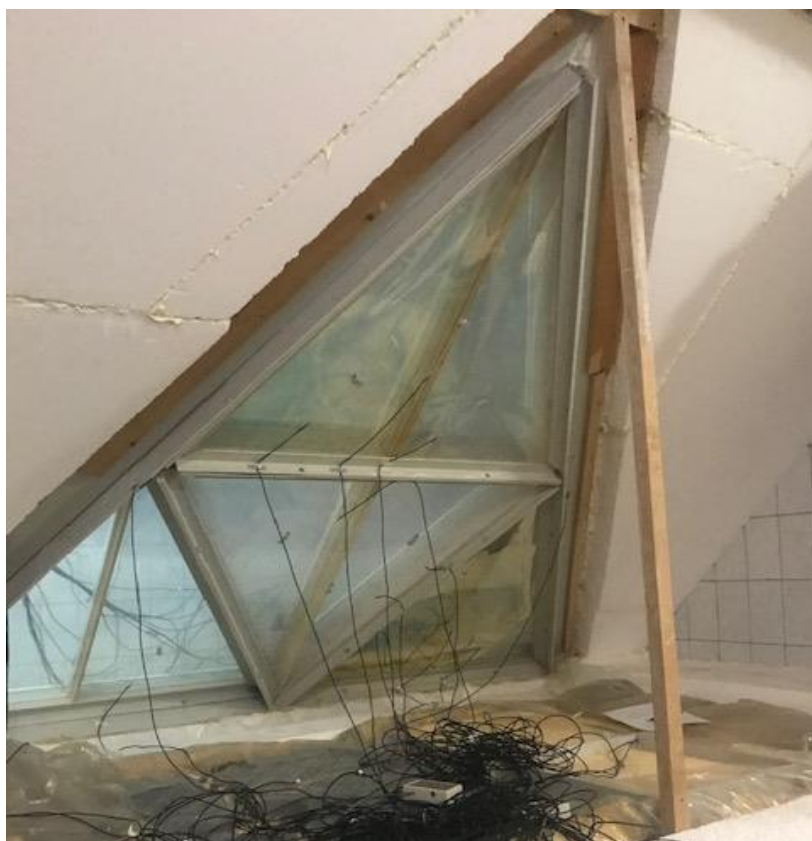
Рис. 11. Сегмент оболочки со стороны теплой камеры с датчиками теплового потока
