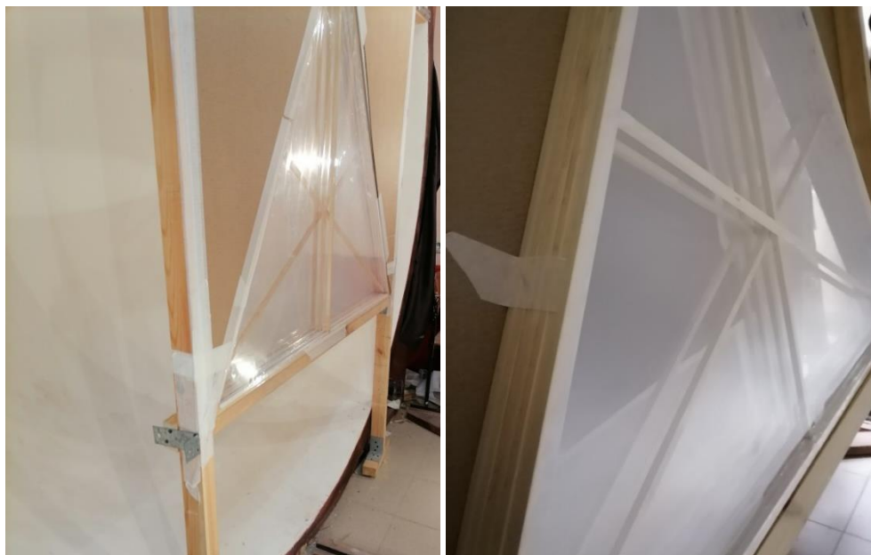
Рис. 8. Монтаж пленкопакетов в светомерных камерах
