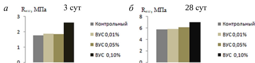
Рис. 7. Результаты испытаний прочности на растяжение при изгибе: а – 3 сут; б – 28 сут
