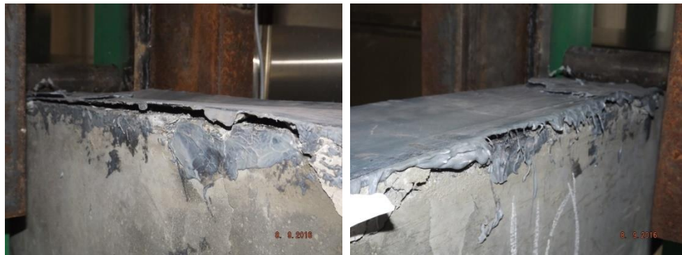
Рис. 5. Вид основных образцов серии «ЖБ-ПП», потерявших несущую способность в процессе испытания на воздействие температурно-силовых факторов
