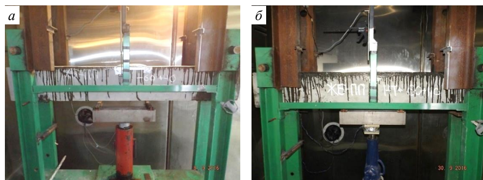
Рис. 2. Испытания основных образцов на одновременное воздействие температуры и внешней длительной статической нагрузки на примере серии «ЖБ-ПП» в интервале температур:
