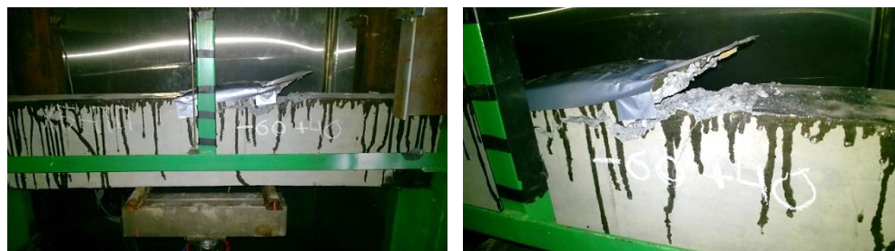
Рис. 5. Вид основных образцов серии «ЖБ-ПП», потерявших несущую способность в процессе испытания на воздействие температурно-силовых факторов
