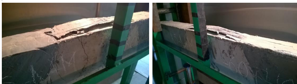
Рис. 6. Вид образцов с повреждениями элементов усиления после воздействия на них температурно-силовых факторов: а – серия «ЖБ-Л»; б – серия «ЖБ-ЛАМ»
