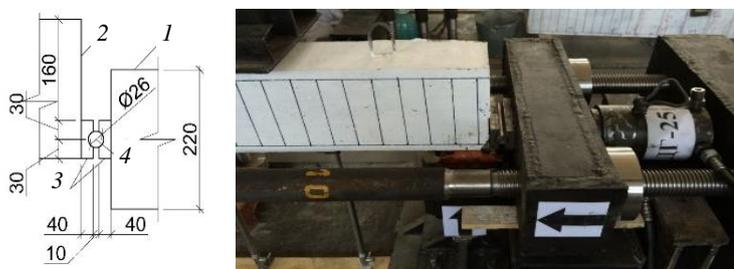
Рис. 4. Узел сопряжения железобетонной балки и торцевой траверсы: траверса (1); железобетонная балка (2); металлическая пластина (3); труба сплошного сечения (4)
