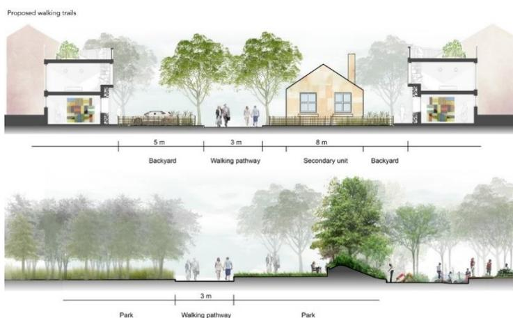
Рис. 13. Разрезы жилой улицы, прилегающей к парку, и парковой зоны, которая отделяется от проезжей части созданной насыпью
