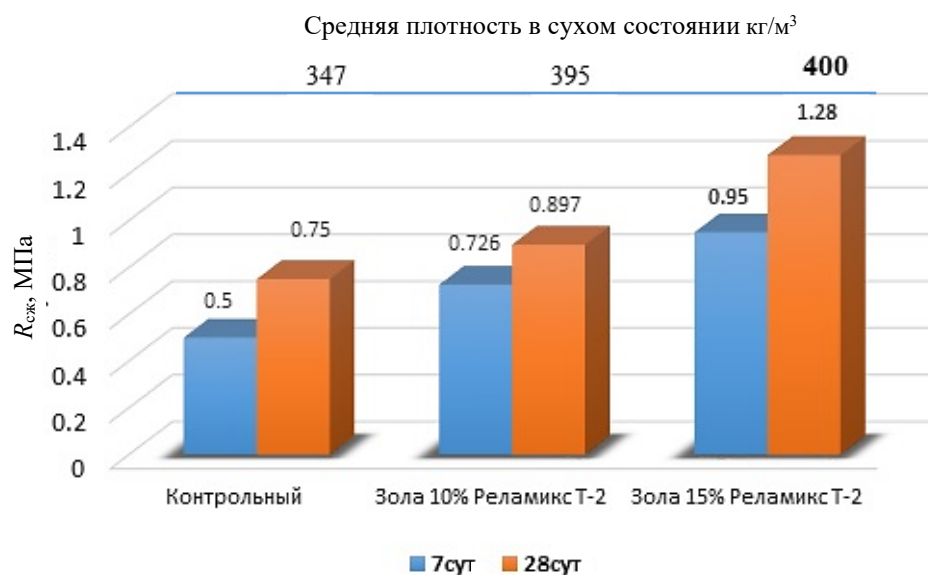
Рис. 3. Влияние пластифицирующих добавок на свойства пенобетона в 7- и 28-суточном возрасте
