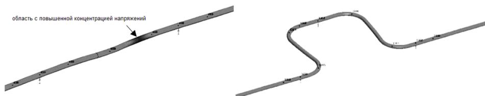
Рис. 2. Замена упругого изгиба (слева) на П-образный компенсатор (справа)
