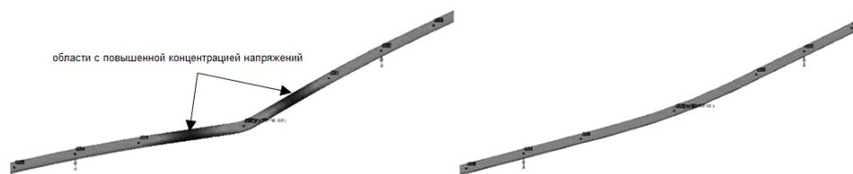
Рис. 1. Замена проектного отвода 5DN (слева) на отвод холодного гнутья (справа)
