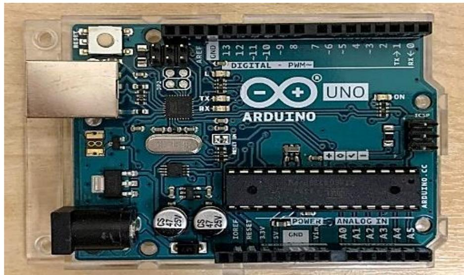
Рис. 2. Платформа Arduino Uno
