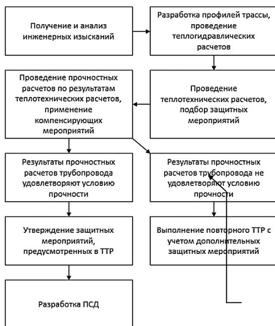
Рис. 5. Блок-схема проведения комплексных теплотехнических и прочностных расчетов подземного трубопровода, прокладываемого через ММГ
