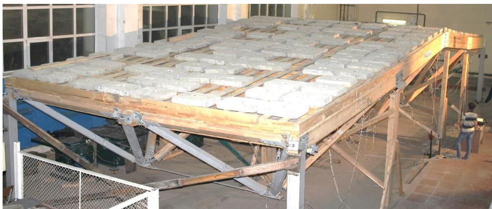
Рис. 2. Структурное покрытие под действием статической нагрузки
