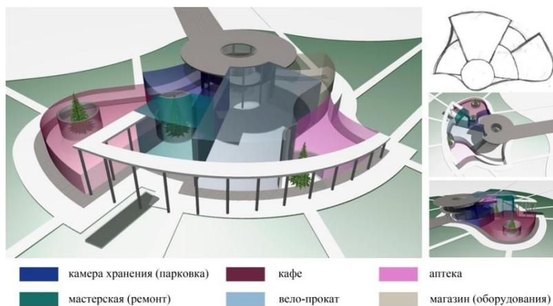
Рис. 5. Центричная функциональная модель городских периферийных велоцентров с эксплуатируемой кровлей
