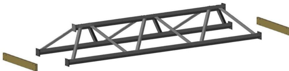
Рис. 9. Устройство торцевых затяжек модуля трёхгранной фермы (положение модуля при доставке и складировании)
