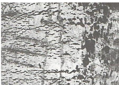
Рис. 1. Коррозионные и стресс-коррозионные дефекты (в плане), обнаруженные на внешней катоднозащищаемой поверхности магистрального газопровода диаметром 1420 мм [1]
