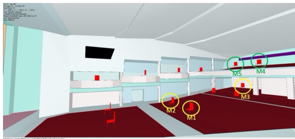
Рис. 1. Компьютерная акустическая модель Большого зала Тюменской филармонии: M1–M5 – контрольные места в зрительном зале для моделирования и измерений
