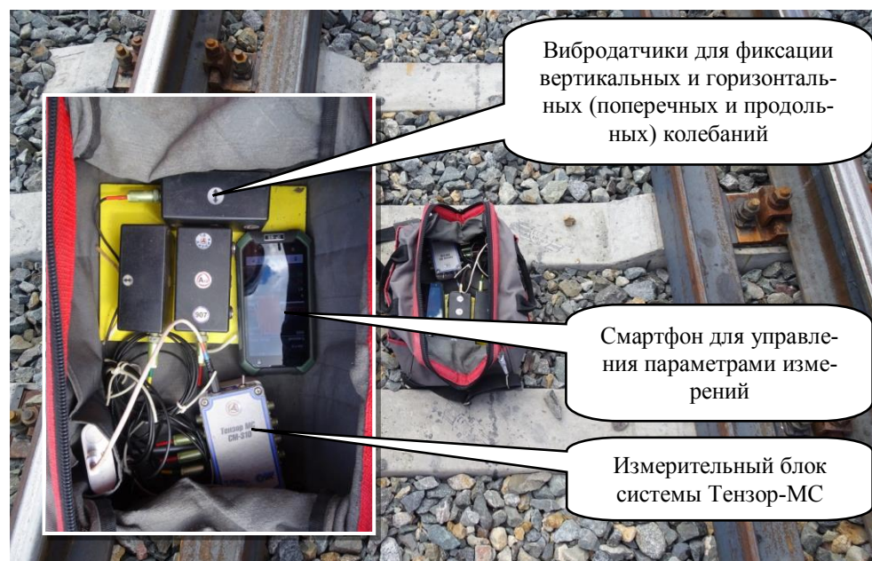
Рис. 4. Измерительная система Тензор-МС для вибродиагностики
