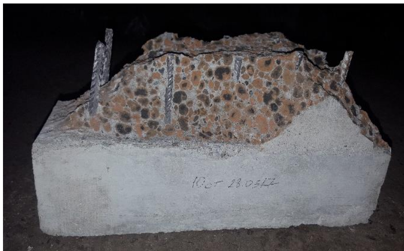
Рис. 5. Разрушение образцов серий Р5 и Р6 (окончание см. на с. 101): а – фото Р5; б – фото Р6
