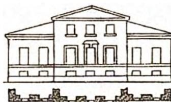
По данному проекту был построен дом купца Давыдова на ул. Пятницкой, 62, в Москве (рис. 4). На главном фасаде здания – семь окон по первому этажу и три окна на мезонине, завершающемся треугольным фронтоном с полуциркульной люкарной и двухскатной крышей. Оконные проемы оформлены профилированными наличниками, а три окна в центре на первом этаже выделены рустом и замковыми камнями.
