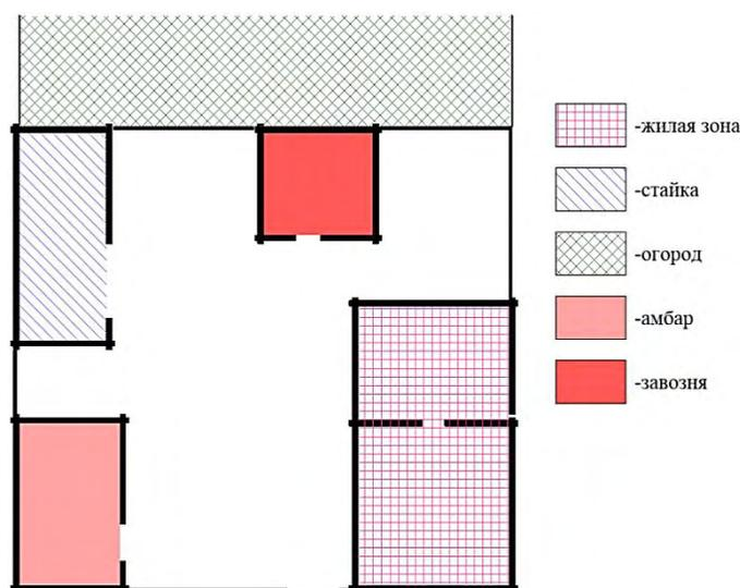
Рис. 3. Принципиальная схема функционального зонирования усадеб свободной планировки, характерная для переселенческих культур. Тип 3
