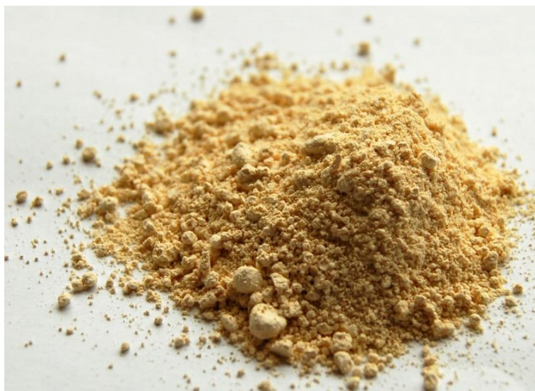
Рис. 1. Фото высушенного осадка промывных вод станции обезжелезивания
