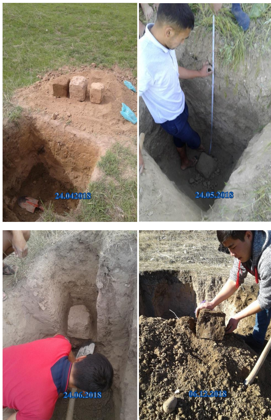
Рис. 3. Процесс отбора монолитов глинистого грунта из откосной части земляного полотна для последующих лабораторных испытаний
