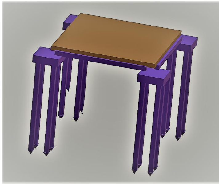
Рис. 1. Конструкция опирания плиты первого этажа
