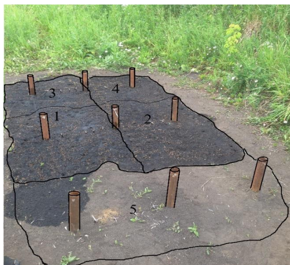
Рис. 2. Вид зоны загрязнения и зоны электрохимической обработки: 1 – массив, загрязненный отработанным маслом; 2 – массив, загрязненный бензином; 3 – массив, загрязненный отработанным маслом с обработкой растворителем; 4 – массив, загрязненный бензином с обработкой растворителем; 5 – чистый глинистый массив
