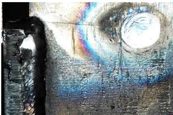
Рис. 9. Торможение роста усталостной трещины в экспериментальном образце индукционной пайкой с прогревом и проковкой
