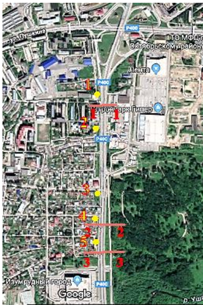
Рис. 2. Схема расположения точек измерения шумовых характеристик и расчетных сечений поперечного профиля: сечение 1-1 – проезжая часть и застройка на одном уровне; сечение 2-2 – проезжая часть находится ниже застройки; сечение 3-3 – проезжая часть находится выше застройки
