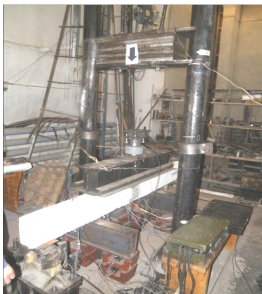
Рис. 2. Общий вид стенда для испытания экспериментальных балок
