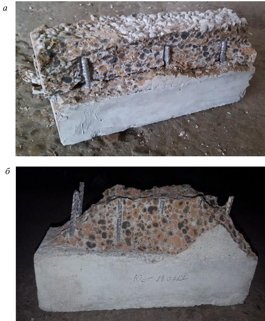
Рис. 5. Разрушение образцов серий Р5 и Р6 (окончание см. на с. 101): а – фото Р5; б – фото Р6
