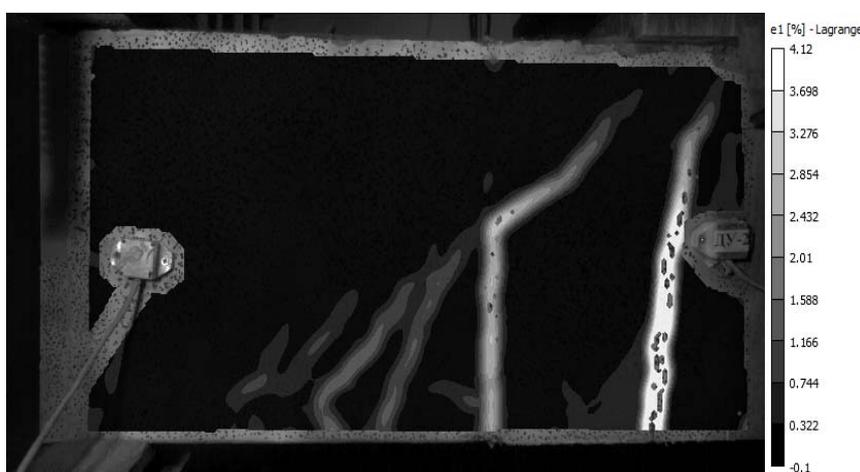
Рис. 6. Деформации на главных площадках от действия второго удара
