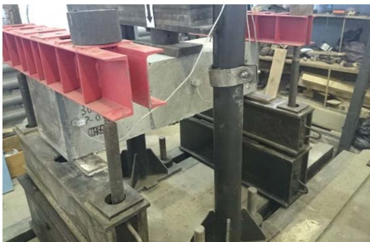
Рис. 1. Узел сопряжения колонны в копровой установке
