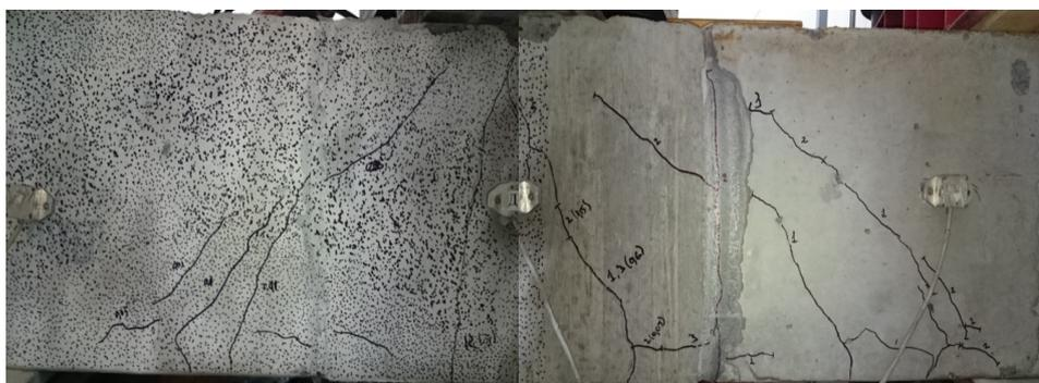
Рис. 7. Картина трещинообразования на поверхности узлового сопряжения
