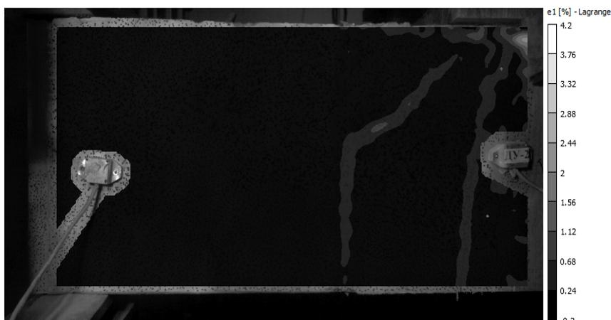
Рис. 5. Деформации на главных площадках в момент контакта ударника с распределительной плитой при втором ударе
