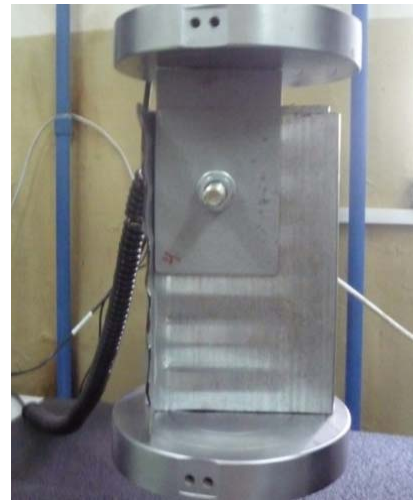
Рис. 8. Натурная модель опорного узла второй серии
