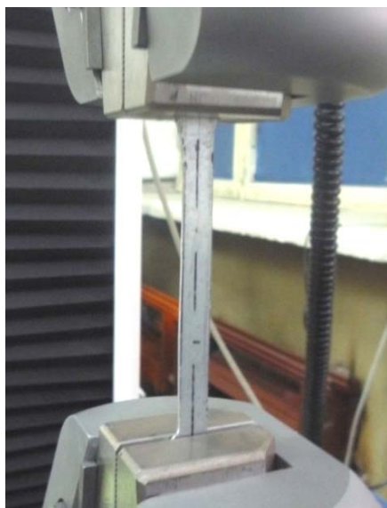
Рис. 9. Стандартный образец выборки испытаний на разрыв
