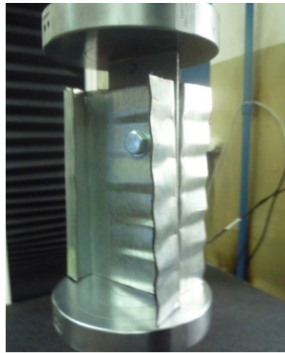
Рис. 7. Натурная модель опорного узла первой серии
