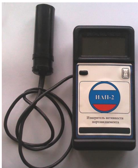
Рис. 3. Прибор для определения марочной активности портландцемента, портландцемента с минеральными добавками и шлакопортландцемента (ИАП-2)
