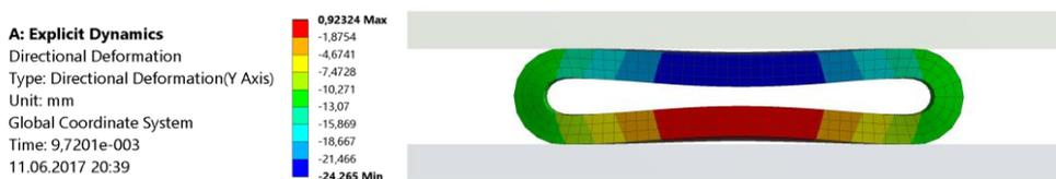
Рис. 12. Общая схема деформирования опоры, работающей в упругопластической стадии (длина опоры 120 мм)
