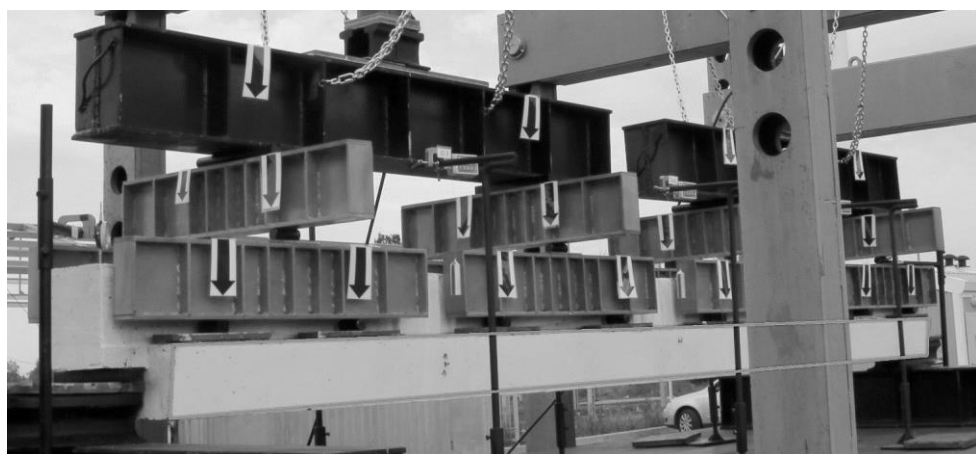
Рис. 4. Общий вид ригеля при испытании с боковой поверхностью, покрашенной резиновой краской «Главный Технолог»
