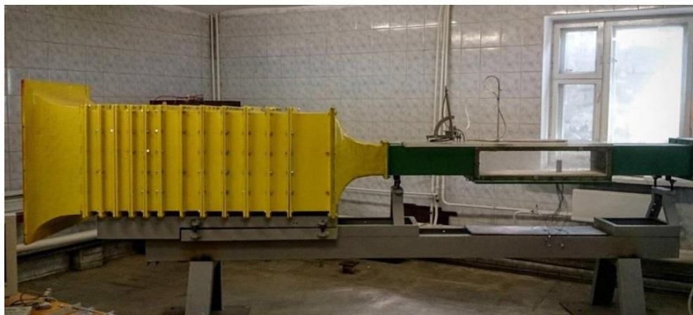
Рис. 1. Аэродинамическая труба
