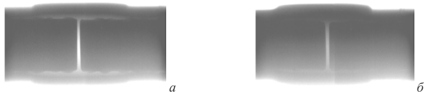
Рис. 2. Радиографическое изображение соединения арматуры с максимальным поперечным размером: а – 47 мм; б – 51 мм
