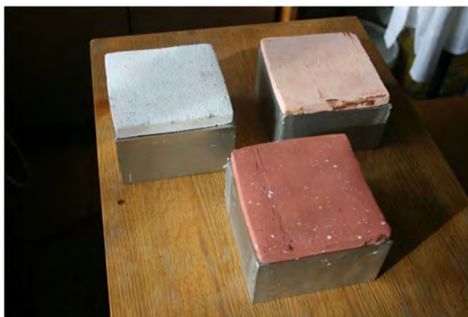
Рис. 1. Образцы, подготовленные для определения паропроницаемости
