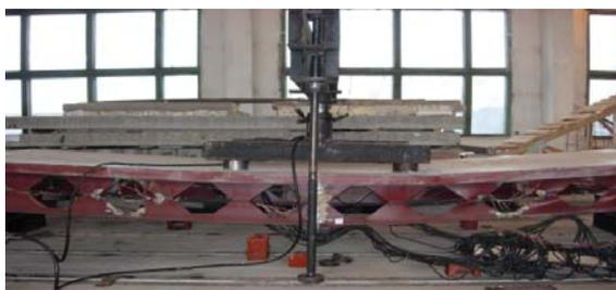
Рис. 1. Балка со сквозной стенкой
