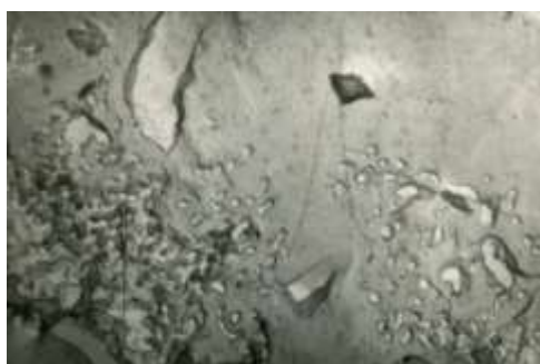
Рис. 7. Микрофотография скола поверхности зёрен обожжённой при 1050 °С аргиллитоподобной глины (электронный микроскоп. × 3000)
