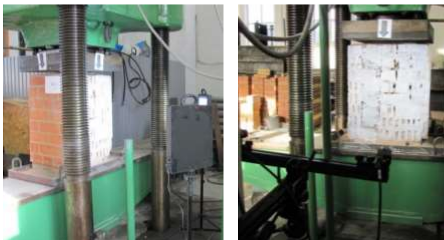
Рис. 3. Общий вид образца, установленного в створ силовой рамы гидравлического прессы ПР-1000М
