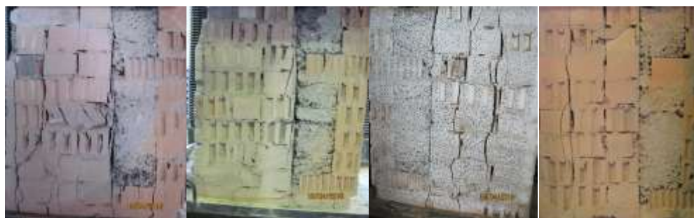
Рис. 6. Общий вид разрушения центрально-сжатых образцов
