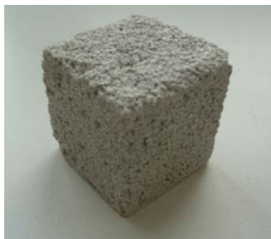
Рис. 2. Теплоизоляционный стеновой материал (средняя плотность – 480–500 кг/м 3 , предел прочности при сжатии – 1,1–1,4 МПа)
