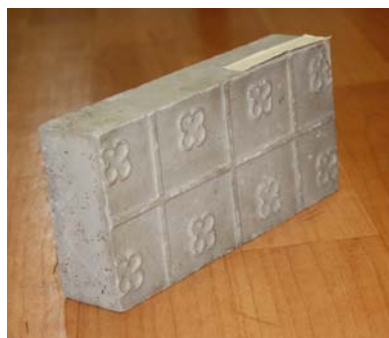
Рис. 3. Конструкционный стеновой материал (средняя плотность – 1550–1900 кг/м 3 , предел прочности при сжатии – 20–35 МПа)
