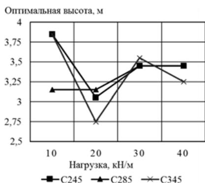
Рис. 2. Изменение оптимальной высоты фермы пролетом 24 м, тип сечения – гнутый профиль, для различных классов стали
