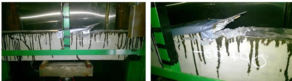
Рис. 5. Вид основных образцов серии «ЖБ-ПП», потерявших несущую способность в процессе испытания на воздействие температурно-силовых факторов
