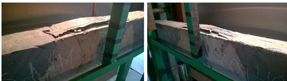
Рис. 6. Вид образцов с повреждениями элементов усиления после воздействия на них температурно-силовых факторов:
