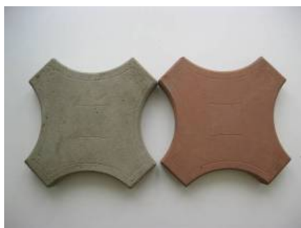
Рис. 5. Непигментированный и окрашенный с использованием кирпично-красного пигмента на основе шлама водочистки образцы тротуарной плитки
