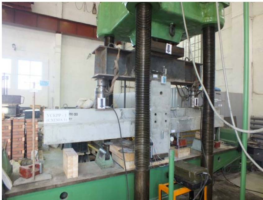
Рис. 4. Общий вид испытания узла сопряжения колонны с ригелями по первой схеме нагружения
